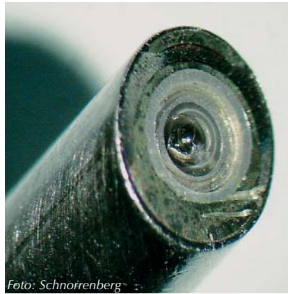
Foto: Schnorrenberg Durch einen Stoßschaden wurden hier Objektiv bzw. Linse beschädigt.
